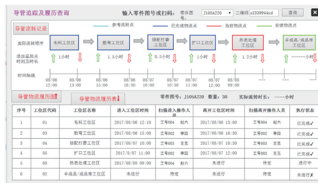
图5 基于二维码的导管物流追踪及履历图表
